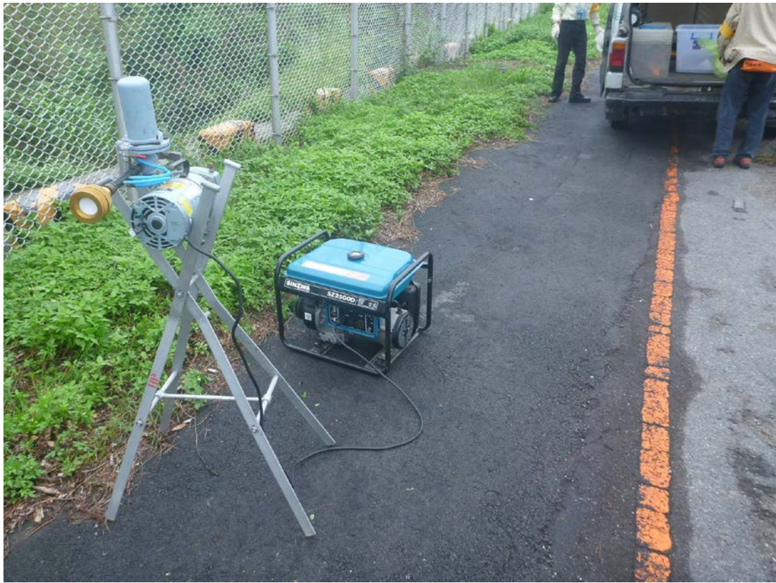
廠界架設空浮取樣器
