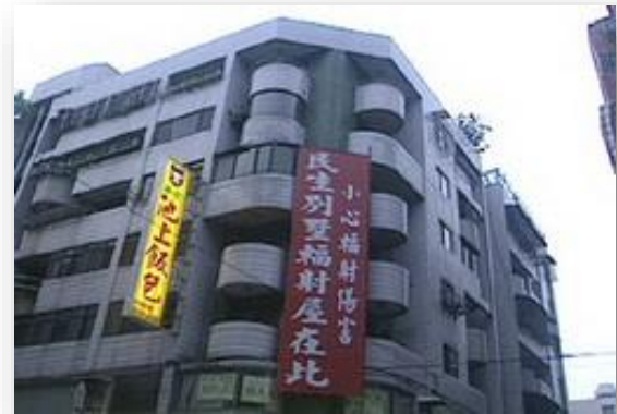
國內輻射鋼筋污染事件： 鈷-60射源誤熔入建材鋼筋內所致
