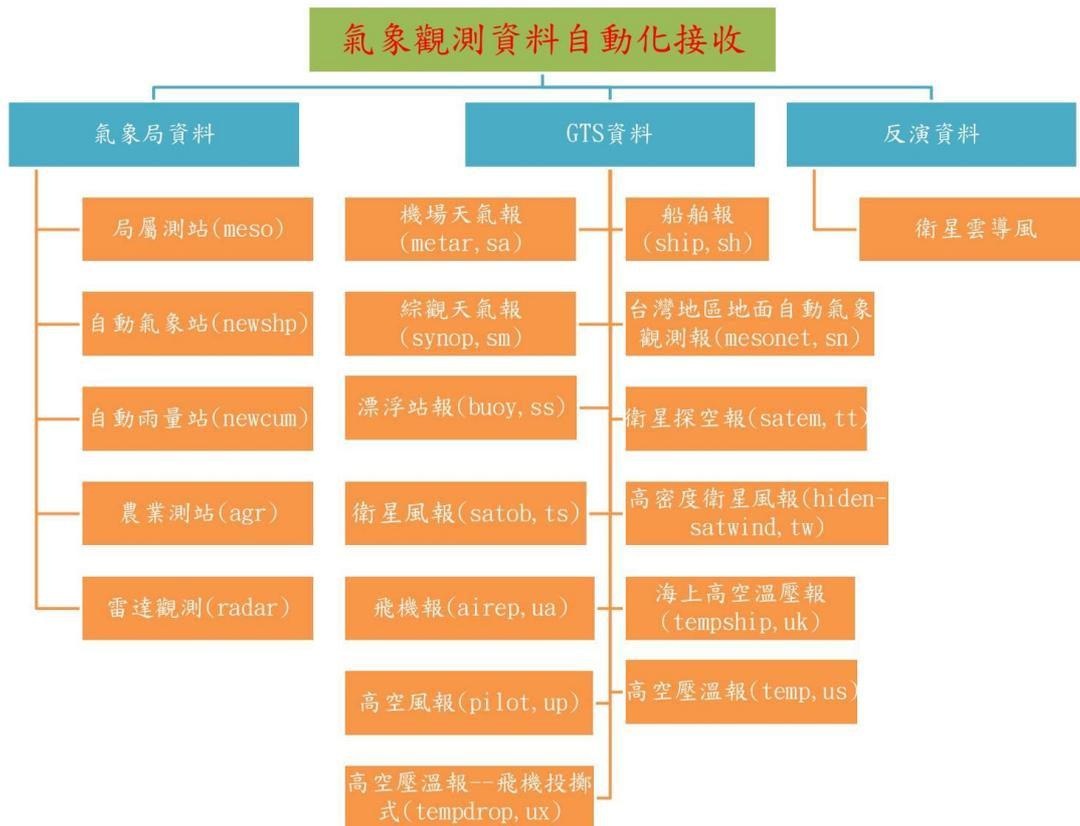
圖 6-1 自動化接收之氣象觀測資料種類
