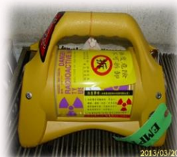
非破壞照相檢測 (Ir-192、Se-75、Co-60)
