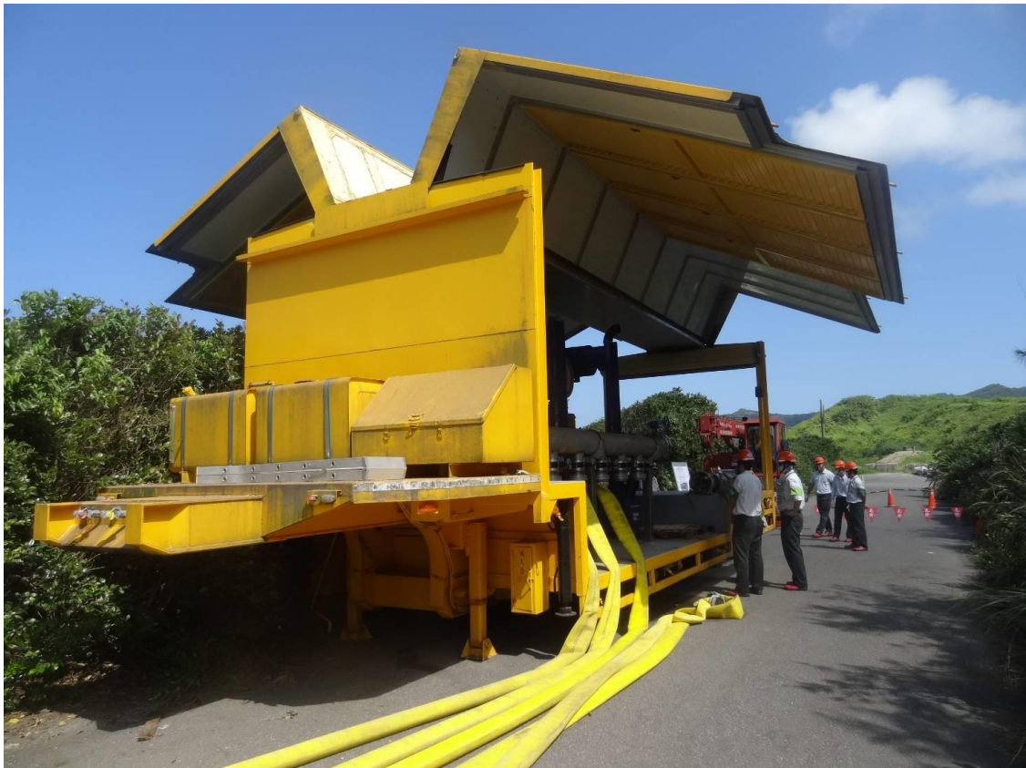
圖 3-17 核能二廠多重水源-鷗翼式車廂拖板車抽取海水演練
