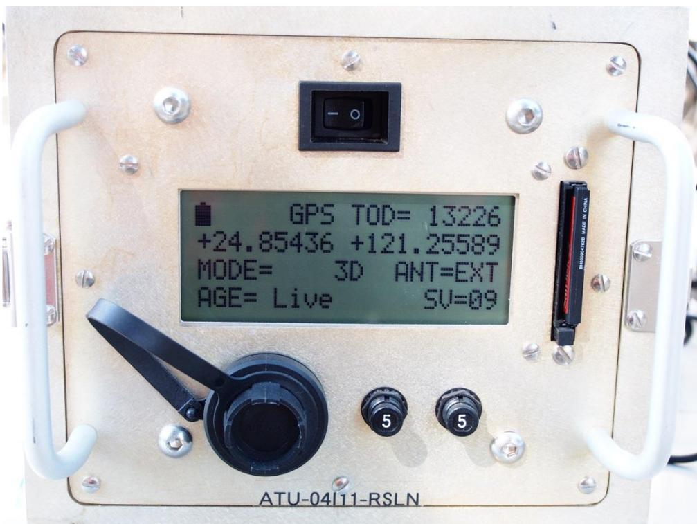
圖 1.17 ATU 顯示 GPS 訊號
