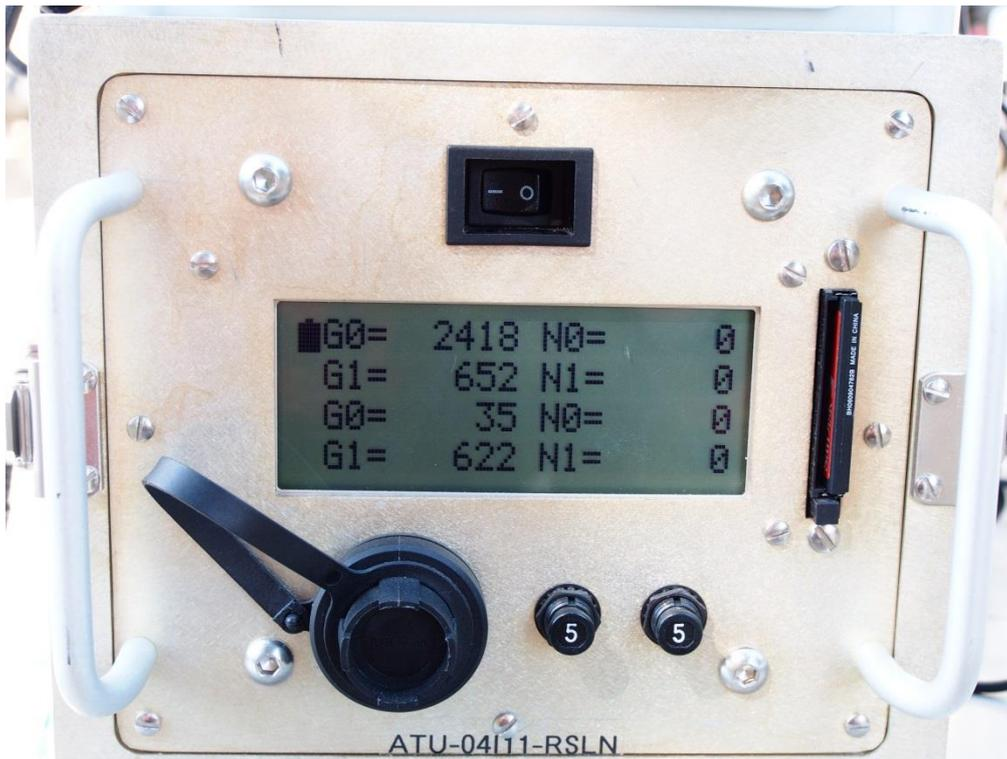
圖 1.16 ATU 顯示碘化鈉偵檢器計數率
