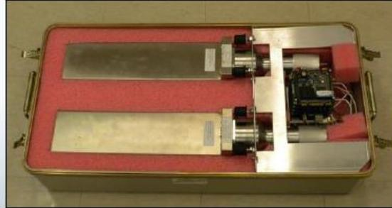
圖 4. 21 SPARCS-M 偵檢器箱之偵檢器規格
