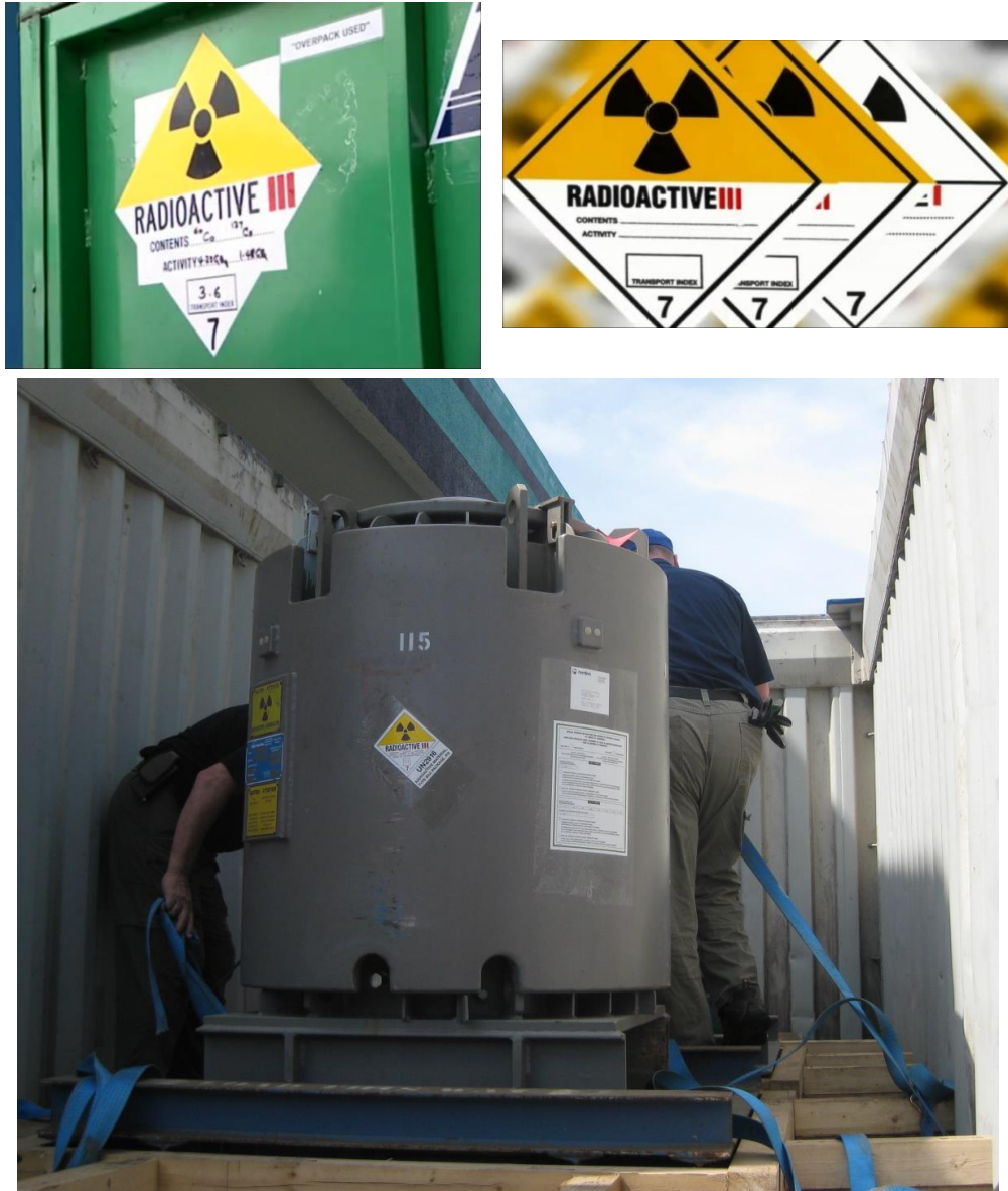
圖 7-4 輻射源辨識示意圖：裝有放射性物質容器或包裹 註：包件的型別與類別進一步說明詳見表 5。
