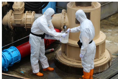
中幅淨水場飲用水源輻射偵測作業
