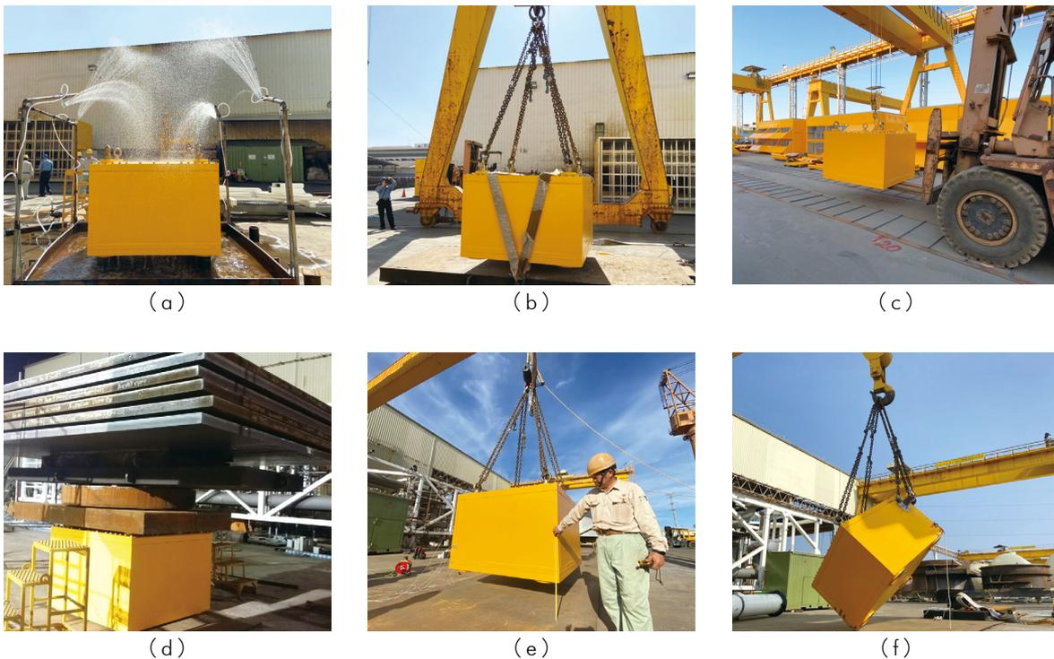
C2 容器試驗：(a) 噴灑 (b) 吊掛 (c) 振動 (d) 堆積 (e) 正向墜落 (f) 傾角墜落
