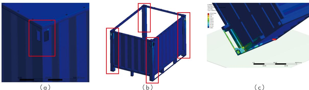
C1 容器分析：(a) 吊掛孔分析 (b) 堆積分析 (c) 自由墜落分析
