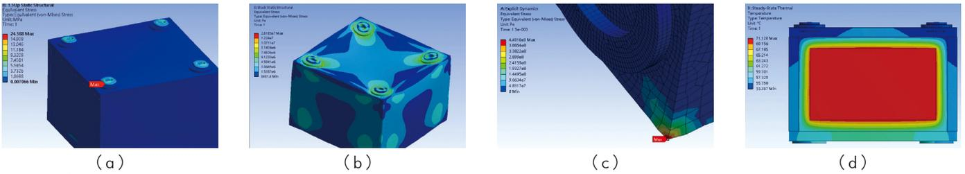
C2 容器分析：(a) 吊掛孔分析 (b) 堆積分析 (c) 自由墜落分析 (d) 熱傳分析
