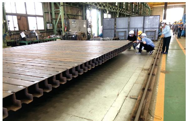
核二廠乾式貯存設施密封鋼筒燃料方管製程作業檢查
