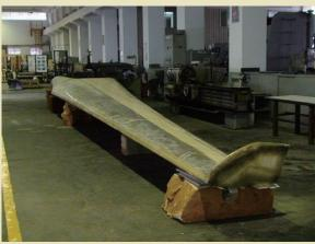
↑The 150kW Wind Turbine Blade
