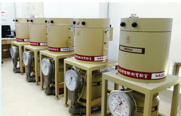
▲ 檢測儀器純鍺偵檢器 High-purity germanium spectrometers
