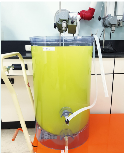
▲ 60 公升海水銫-137 前處理 Cs-137 Pre-treatment Process of 60 liters of Sea Water.
