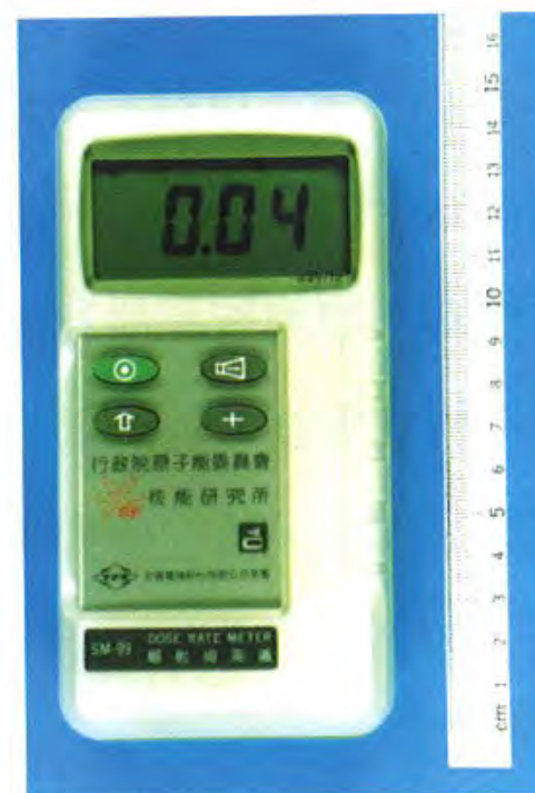
核能研究所 SM-99 輻射偵測器
