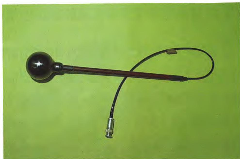
核能研究所自製石墨球型游離腔
