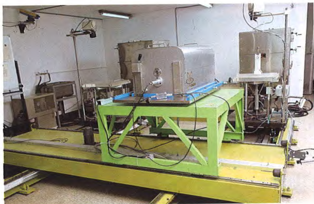
核能研究所自製達國際標準的「自由空氣游離腔」
