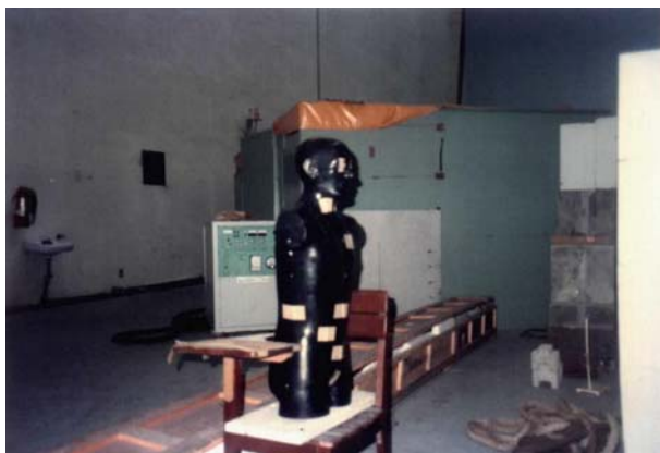
圖 7.1 熱發光劑量計在清華水池式反應器量測劑量。
