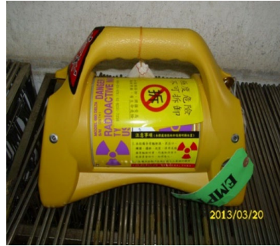
放射線照相檢驗設備
