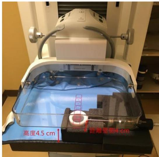
圖 1-7-1：入射表面曝露測量之劑量計設置架構
