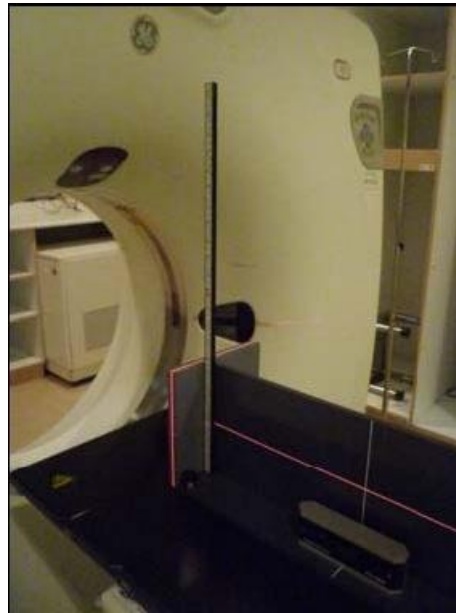
圖十四、尺直立於檢查床上，設定兩側雷射向上及向下各移動固定距離。
