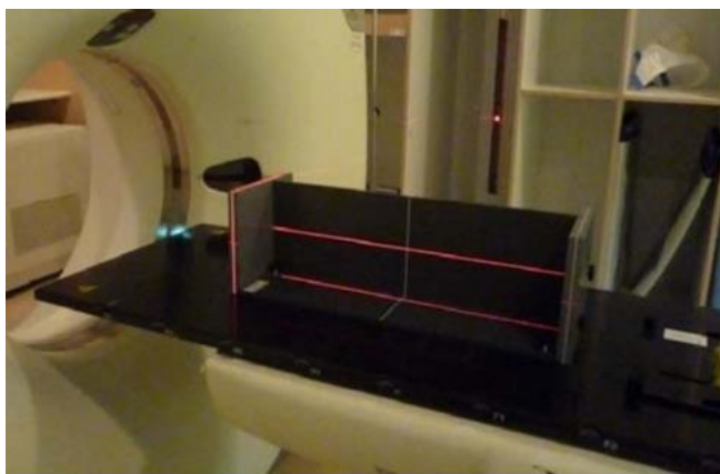
圖九、在多平面的不同位置皆內含兩個以上直徑 2 毫米圓形孔洞的測試假體。
