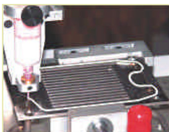
圖三十二 連接板密封材料自動塗佈設施
