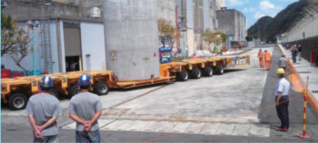
▲ 於核能一廠執行混凝土護箱運送測試
