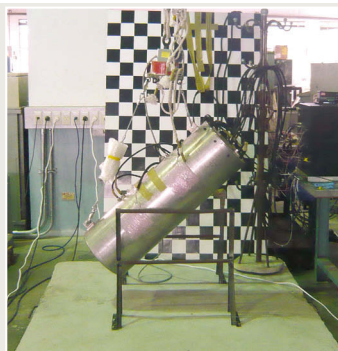
▲密封鋼筒(1/5模型)墜落撞擊實驗：垂直墜落(左)傾斜墜落(右)
