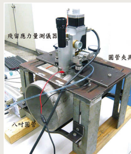
▲不銹鋼管殘留應力量測
