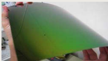
▲長3,000mm 幅寬370mm金屬捲材基底之矽薄膜鍍製成品展示
