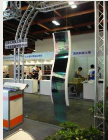
▲長3,000mm 幅寬370mm金屬捲材基底之矽薄膜鍍製成品展示
