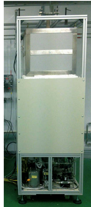
▲kW級SOFC系統
