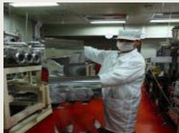
▲自主開發捲揚式電漿PECVD系統
