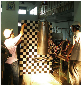
▲密封鋼筒(1/5模型)墜落撞擊實驗：垂直墜落(左)傾斜墜落(右)
