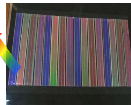
▼小型薄膜太陽能電池模組 130mm×150mm
