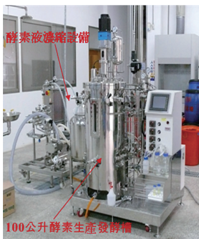
▲ 核研所實驗型酵素生產設施
