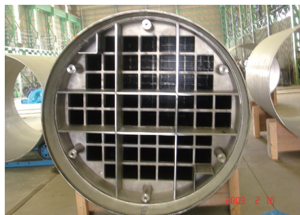
▲ 乾式貯存密封鋼筒製造製成品
