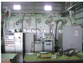
▲ 大型先進電漿被覆系統
