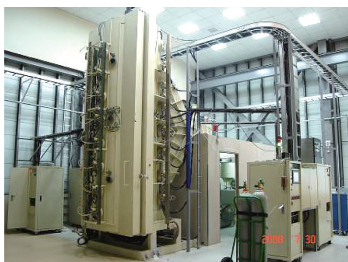
▲ 高聳直立式電漿被覆系統
