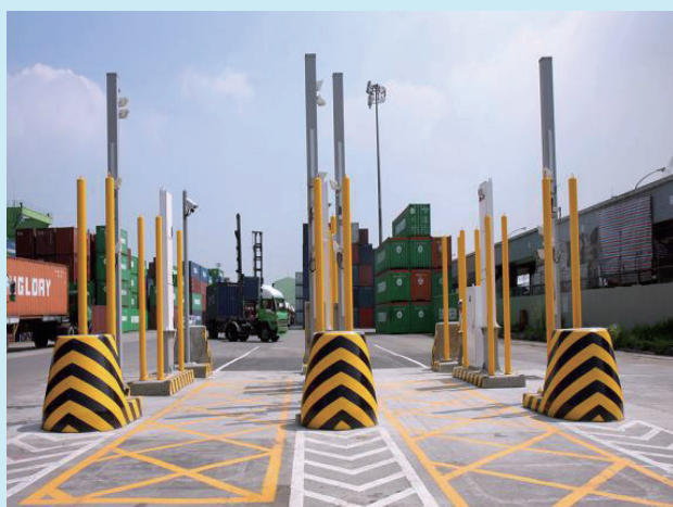
◀ 門式輻射偵測器 (RPM)
