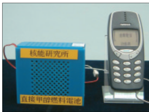
圖十九、DMFC膜極組合(添加1.5C.C甲醇可供手機通話75分鐘)
