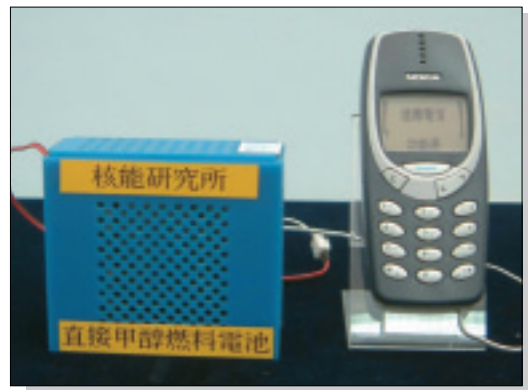
圖五十、DMFC膜極組合（添加1.5C.C 甲醇可供手機通話75分鐘）
