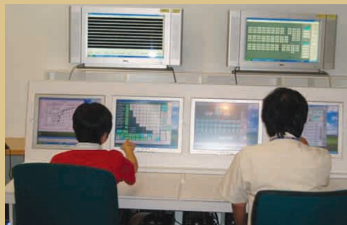
↑核能四廠數位儀控系統人機介面驗證測試
