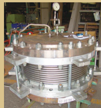
↑核能三廠金屬膨脹接頭水壓測試
