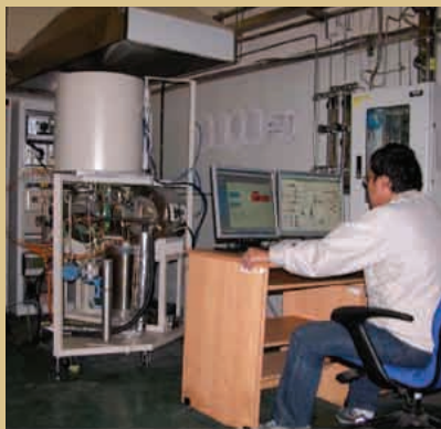
↑ 1 kW SOFC發電系統實體圖。
