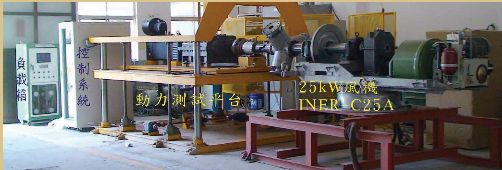
↑200kW級地面測試動力平台
