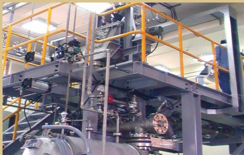
↑小型連續式螺旋輸送前處理系統
