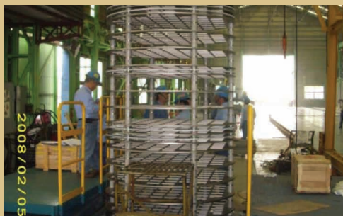
↑ 測試用鋼筒製造－提籃組裝
