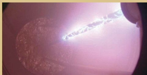
↑5米之柱形陰極電弧電漿源（1米處電漿密度 1 \times 10^{11} \text{cm}^{-3} ，均勻度 < 10\% ）
