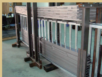
↑核能四廠電纜托架檢證—機械負載測試
