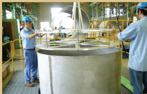
↑ 密封鋼筒製造－鋼筒外殼 go gauge 測試
