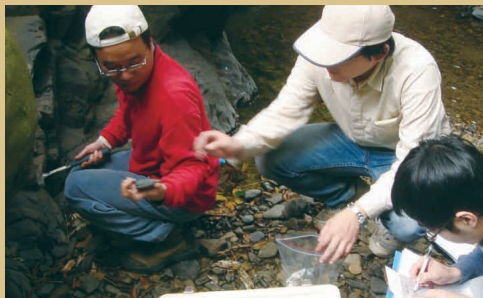
↑台電公司97年2月13~15日於本島東南部進行潛在場址調查及採樣作業期間，原能會物管局派員進行檢查作業。岩石採樣時，對於風化及銹染之岩樣，要求審慎剔除。
