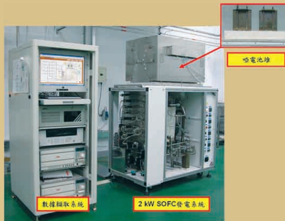
↑ 2 kW SOFC發電系統箱型化設計實體圖
