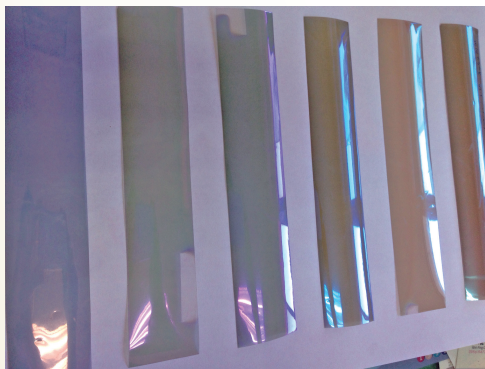
▲輕薄可撓 PET 膜上調變出各種色彩之節能膜
