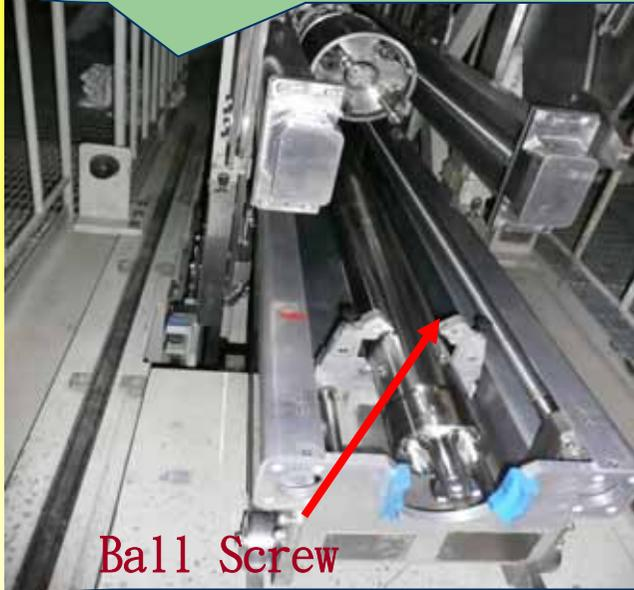
11. 利用FMCRD Handling Device 將FMCRD(UC)豎直。
