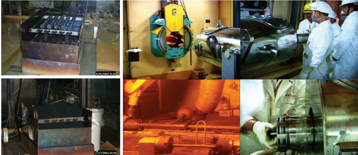
■ 圖六十三 待安定化處理之脫鞘金屬鈾棒(左上)安定化處理後之產物 U_3O_8 粉片(左下)TRR燃料及安定化產物進出熱室作業(右)
