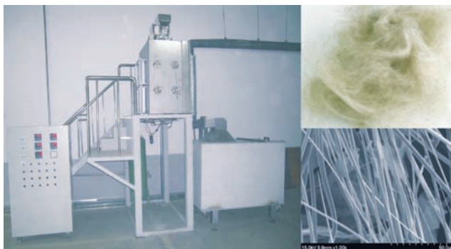
圖一〇三 岩礦纖維製作設備及試製產品 (左：岩礦纖維製作設備；右上：岩礦纖維產品；右下：岩礦纖維SEM圖)
