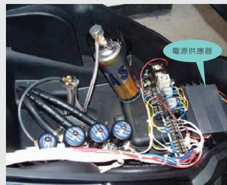
■ 圖一一一 小型高壓高頻電源供應器及控制元件
