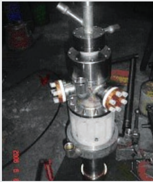
■ 圖九十八 600kW非傳輸型蒸氣直流電漿火炬
