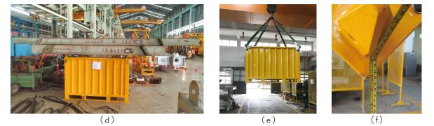
C1 容器試驗: (a)噴灑 (b)吊掛 (c) 振動 (d) 堆積 (e) 正向墜落 (f) 傾角墜落 Tests on C1 container: (a) water spray (b) hanging (c) vibration (d) stacking (e) straight drop (f) angle drop
