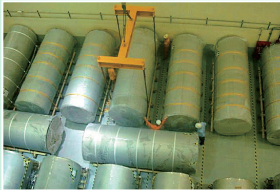
▲核能一廠25只密封鋼筒暫存於倉庫內
