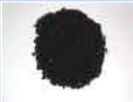
圖七十九 水淬熔岩 d_{50}=2.24\text{mm}
