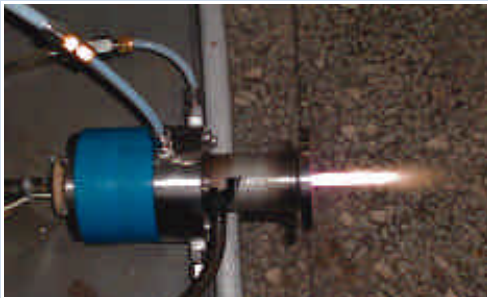
圖八十五 小功率 (5~15kW) 非傳輸型直流電漿火炬
