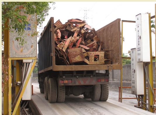
↑ 廢鋼進廠經門框式偵檢器輻射偵測
