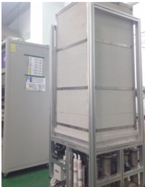
▲3 kW SOFC發電系統實體照
