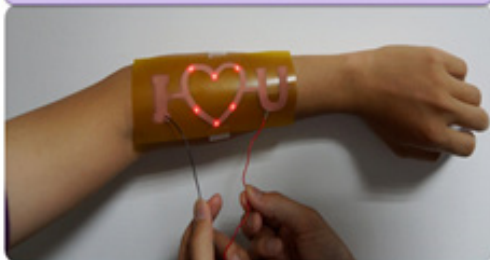
銅油墨藉由噴墨修補PCB電路
