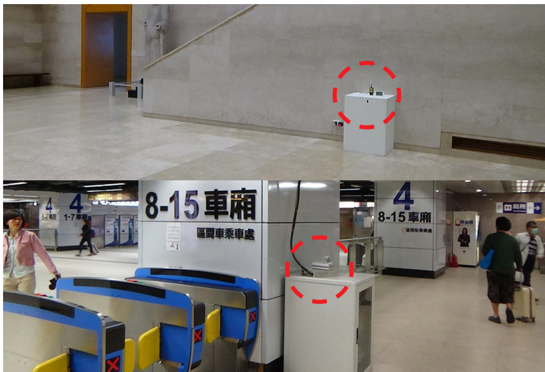
▲高雄美術館展場與台北車站月台出入口進行氡氣量測。
