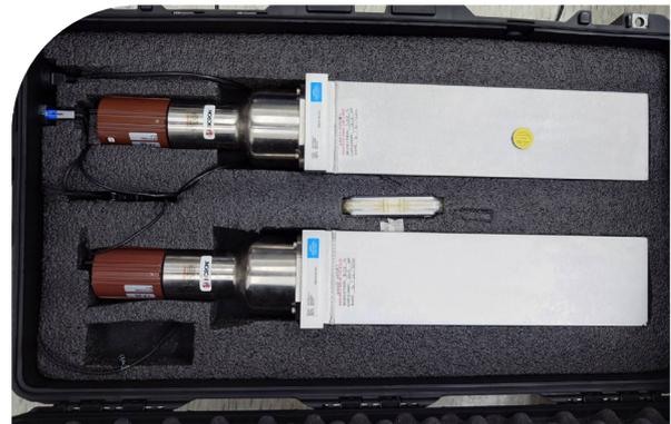
升級多頻道能譜核儀模組的空中輻射偵測 SPARCS 系統
