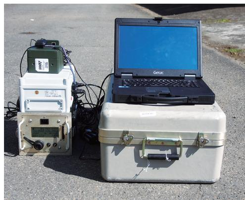
▲進步型輻射能譜量測電腦系統
