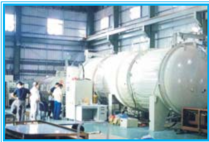
▲超大型電漿鍍膜設施 ( \phi 2400 \times L8500 )
