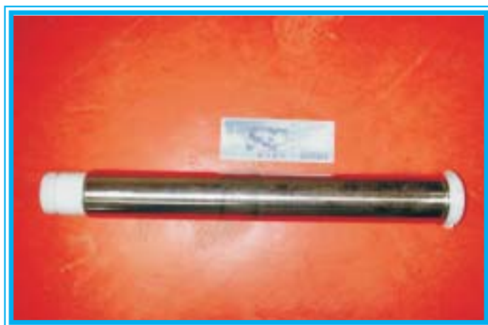
▲兩端鍍鋁之飛機起落架
