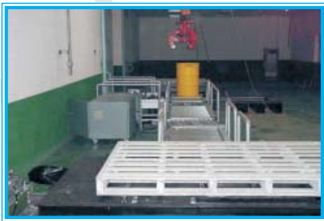
▲55加侖桶裝廢料檢測自動輸送系統
