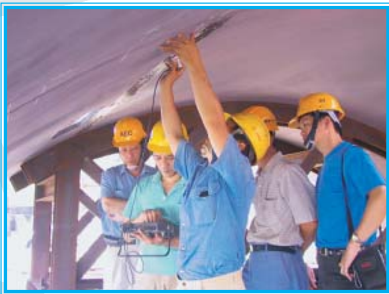
▲ 核四廠反應爐第一層基座實施超音波檢驗
