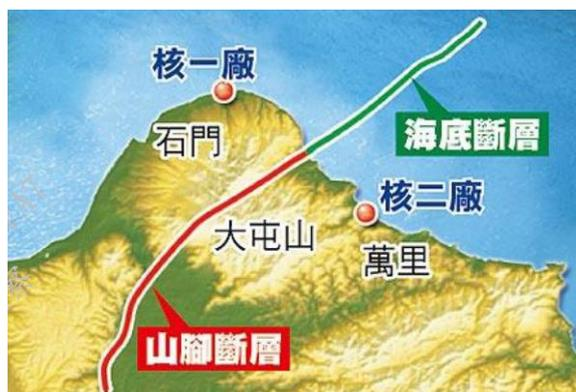
圖 3-5 引用田委員簡報之山腳斷層示意圖，原能會已要求台電公司假設山腳斷層向海域延伸並以總長度為 114 公里的基礎下進行核一、二廠耐震評估及補強
