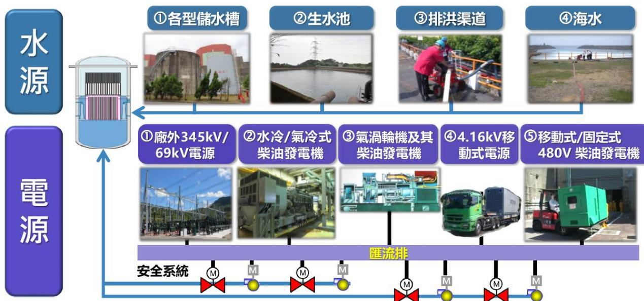
圖 3-2 斷然處置程序之多重多樣水源與電源
