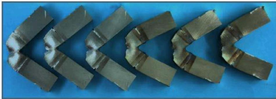
圖 4-8：庫存材料經 Charpy-V 衝擊韌性測試後的試片(摘錄自參考資料 3)
