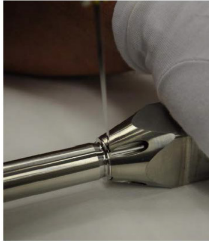
圖 13、厚薄規測量壓接處間隙
