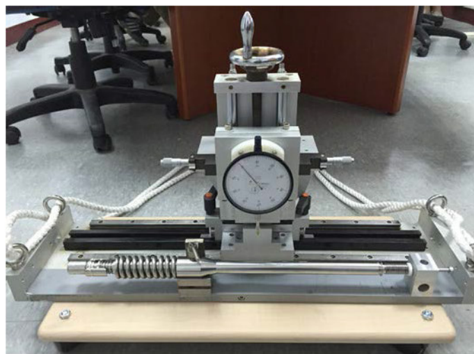
圖30、連接桿準直度量測工具
