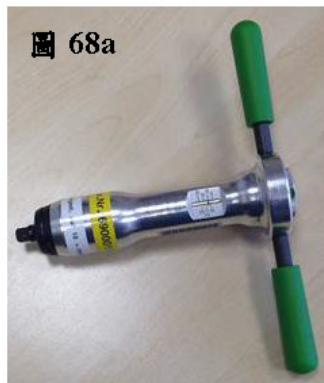
圖 68、自動解脫(Clutch Release)扭力扳手
