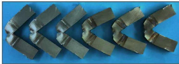
圖57、經Charpy-V衝擊韌性測試後的試片
